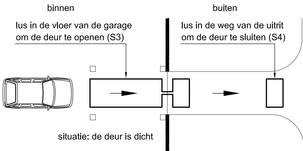
Je gaat de elektrische installatie voor de garagedeur monteren op een montagebord. De detectielussen worden daarbij gesimuleerd met de drukknoppen S3 en S4..
